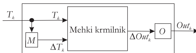
Slika 10.9: Shema krmilnika za uravnavanje željene ambientalne temperature.
